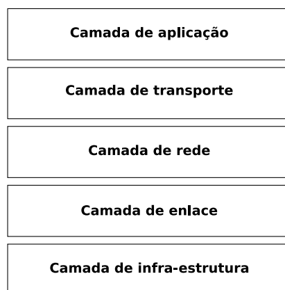
Figura 6.1: Modelo em camadas OASIS para redes de anonimização.
