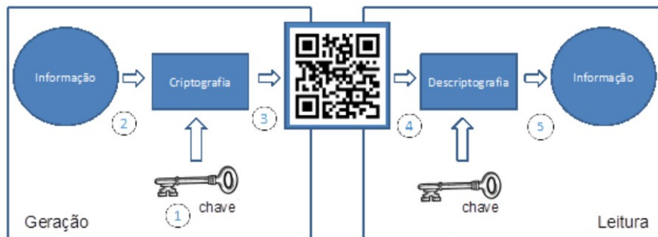
Figura 5: Fluxograma que mostra o passo a passo do processo de cifragem e decifragem da informação contida no QR Code.
