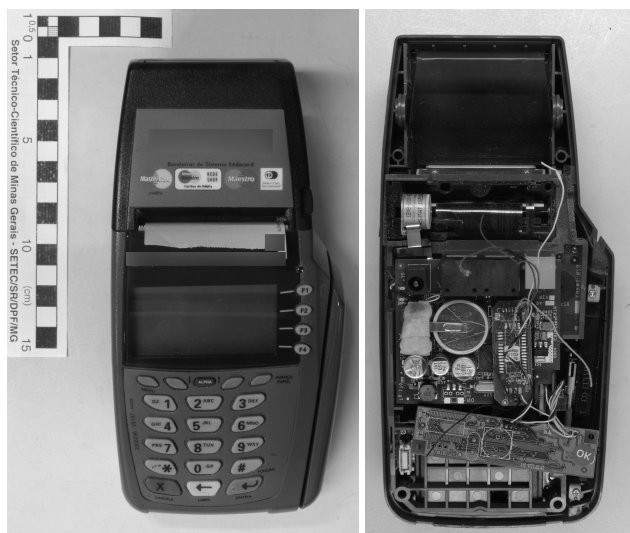
Figura 4. Visão externa e interna de um POS adulterado.
