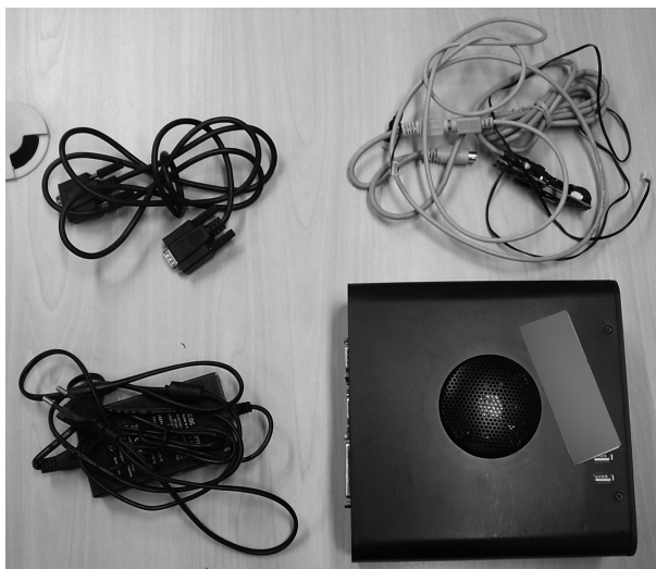
Figura 3. Mini CPU e acessórios para serem instalados dentro de um ATM.
