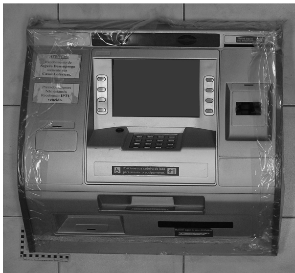
Figura 1. Frente falsa a ser sobreposta em um ATM.
